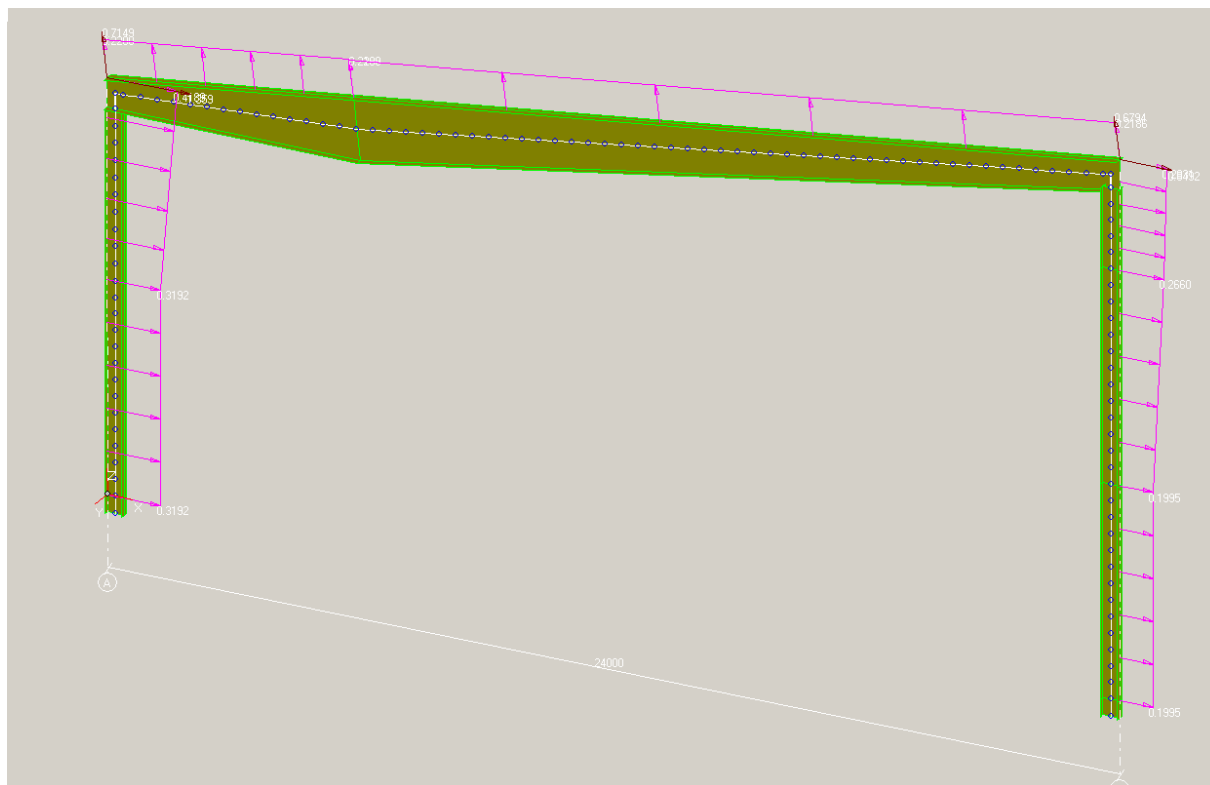
Рис. 1. 3 Двухшарнирная однопролетная одноэтажная рама с жестким сопряжением колонн с фундаментом и шарнирным сопряжением ригеля с колоннами. Односкатная кровля.
